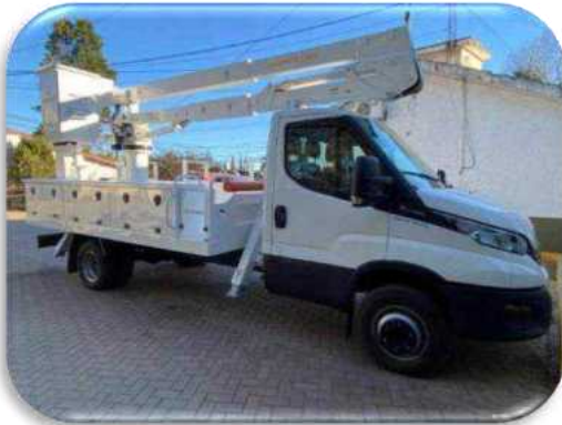
Camión IVECO DAILY 70-170 equipada con un hidroelevador doble aislación 13 metros Año 2025 – Dominio SDJ 3252 (provisoria)
