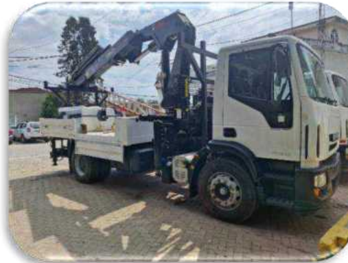
Camión IVECO EVO TECTOR E5 170E28 4185 MLC equipado con una hidrogrúa 25 TN Año 2025 – Dominio SDJ 325 (provisoria)
